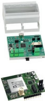
*XMULTICOM, équipé d'un dispositif XWBL ou XMB, peut contrôler un automate compatible XRS485 et d'autres automatismes génériques (par exemple, des lumières, un système d'irrigation, etc.).*
